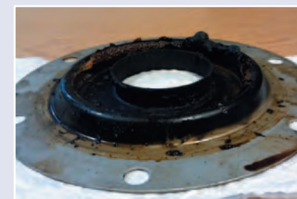
Возгорание неоригинального маслоотделителя внутри компрессора
