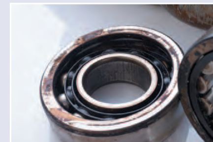
Окисление подшипника при применении неоригинального масла
